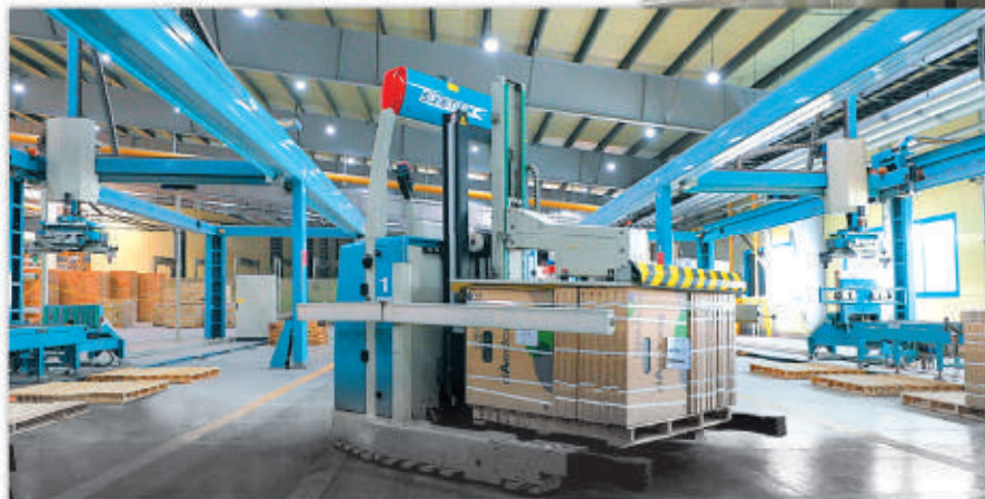
AGV · 팍렛타이저 | 자동 적재 시스템
